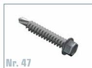
Bohrschraube d=6,3 mm Länge (mm): 45–80 Einsatz bis zu einer Materialstärke von 6 mm
