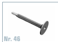
Bohrschraube d=6,3 mm Länge (mm): 55 und 65 Einsatz bis zu einer Materialstärke von 6 mm
